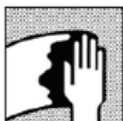
Dégraisser avec le 8241 à l'aide de chiffons propres
